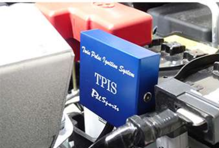
5. 配線を束ねてから本体を バッテリー付近に取り付ける
