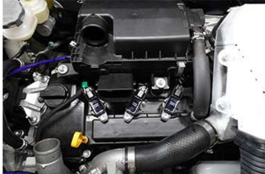
2. エアーダクト等外す
